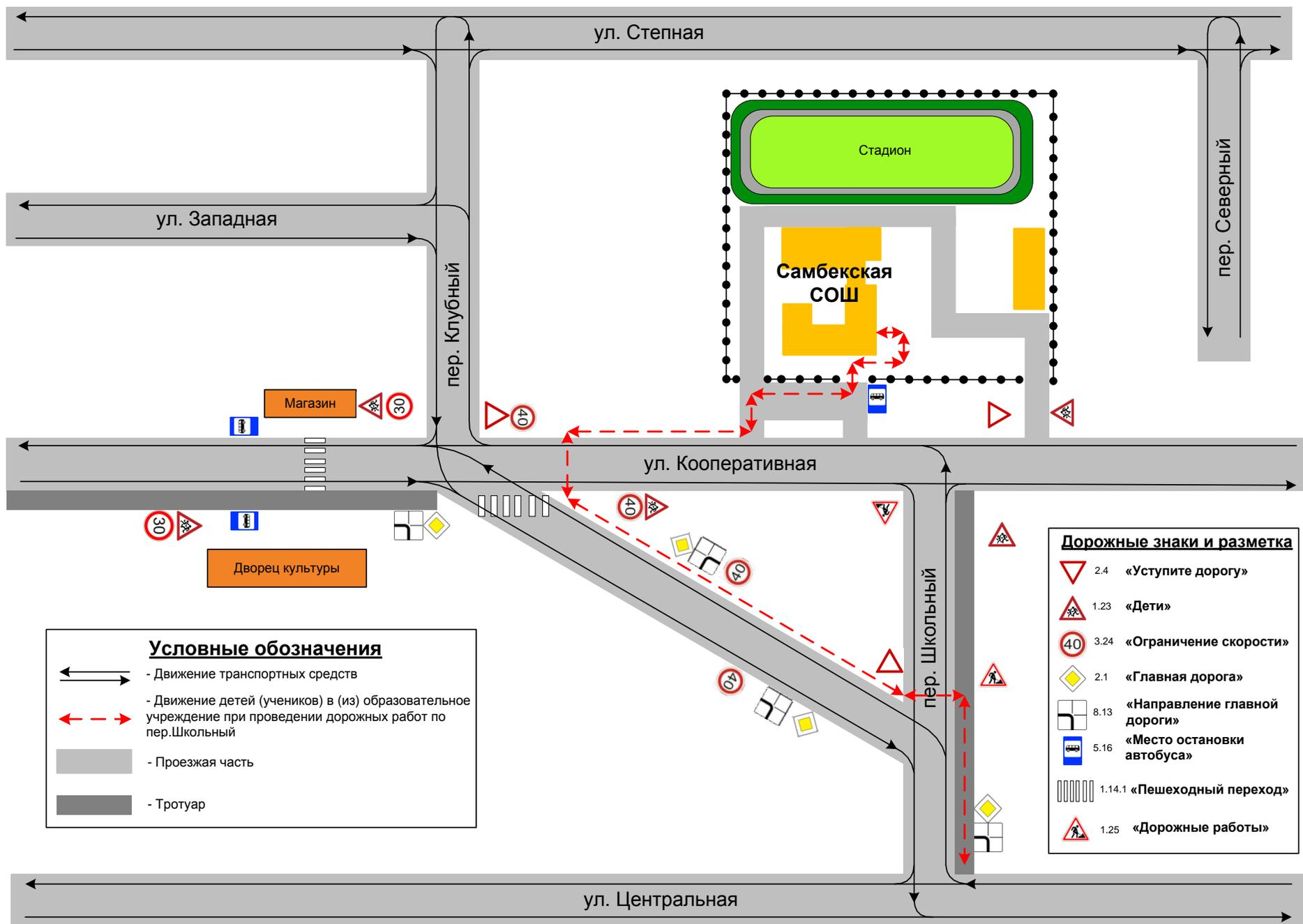
План-схема пути движения транспортных средств и детей (учеников) при проведении дорожных ремонтно-строительных работ. План 2
